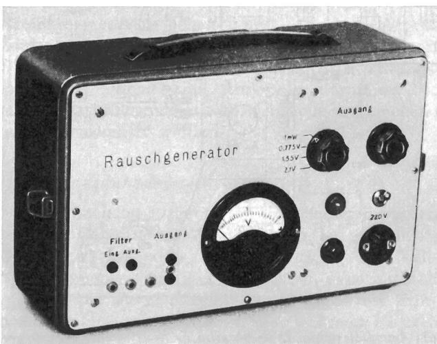
Fig. 2. Rauschgenerator in transportabler Ausführung
