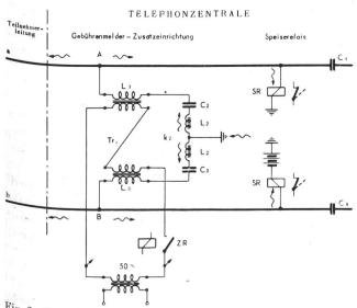
Fig. 2. Um die Dämpfungserhöhung zu vermeiden, wird der Impulsübertrager in die Resonanzbrücken  $\mathbf{k}_2$  eingeschaltet
