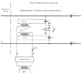
Fig. 3. Die Speisestromleitungen werden gleichzeitig auch für die Gebührenmelder-Impulsübertragung benützt
