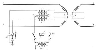
Fig. 5. Die vorgeschlagene Schaltung der Gebührenmelder-Zusatzeinrichtung
