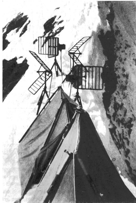
Fig. 5. Station relais du Jungfrauoch (3650 m) ayant servi aux essais de transmission par ondes décimétriques dirigées Chasseral-Lugano (emplacement b) en 1948.
