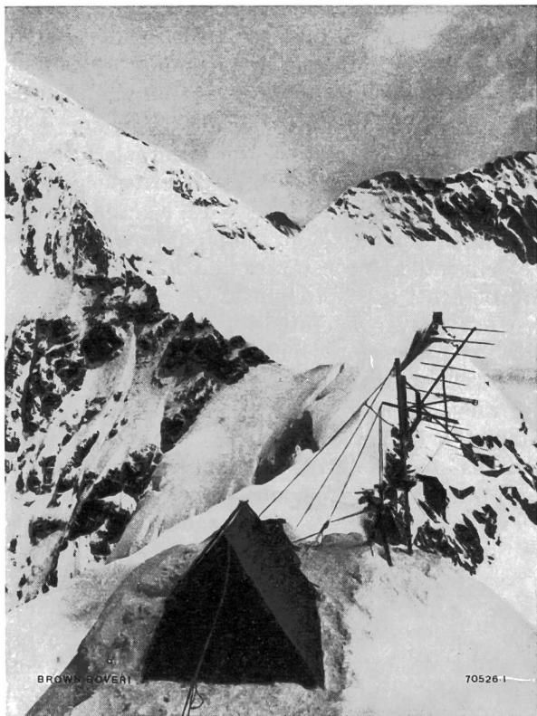
Fig. 6. Installation d'essais de transmission par ondes dirigées de 2 m sur l'arête nord-est de la Jungfrau (3660 m). Les appareils de mesure sont installés dans la tente. Au-dessous de l'observatoire du Sphinx, on voit dans les rochers, de gauche à droite, le nouvel hôtel, l'ancien hôtel et la station de recherches de haute montagne.
