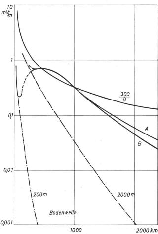
Fig. 1. Propagation de nuit au-dessus du sol ( $\sigma=10^{-13}$  U.E.M. abs.). Quasi-maximum pour une puissance de rayonnement de 1 kW. (Londres 1937)
