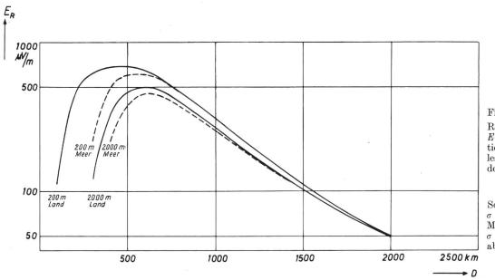
Fig. 2. Rayonnement indirect  $E_R = E_N - E_D$  en fonction de la distance pour les longueurs d'ondes de 2000 et 200 m
