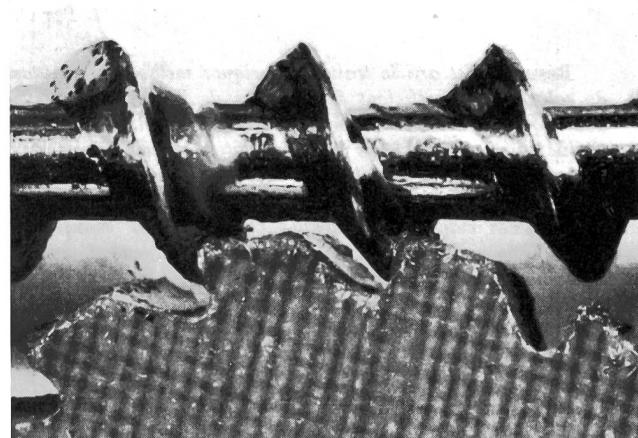
Fig. 23. Nummerschalter Nr. 1. Man beachte die Fettablagerungen am Rand der Schnecke
