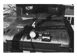
Fig. 4. Rangierlokomotive mit Funkantenne und einer der an beiden Enden angeordneten Sprechstellen. Schutzkasten geöffnet, Mikrotelephon auf Gabel liegend sichtbar
