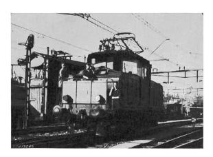
Fig. 6. Mit Rangierfunk ausgerüstete Rangierlokomotive. Der Rangiermeister, Chef der Rangiergruppe, telephoniert während der Fahrt von der Lokomotive aus
