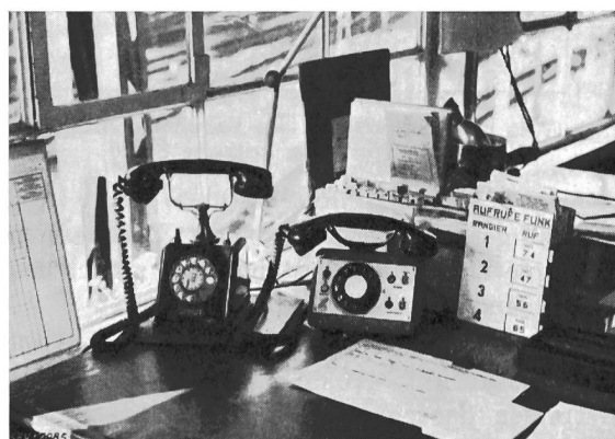
Fig. 5. Sprechstelle der Rangierfunkanlage auf dem Tisch des Aufsichtsbeamten im Hauptstellwerk. Sprechstelle mit Betriebsanzeigelämpchen, Nummernscheibe und Fernschalter mit Kontrolllampen für Sendevorheizung und Empfänger
