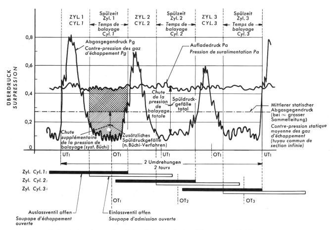
Fig. 3. Die Druckschwankungen eines Sechszylinder-Dieselmotors. Erläuterungen siehe Text Les variations de la pression dans un moteur Diesel à six cylindres. Pour les explications, voir le texte
