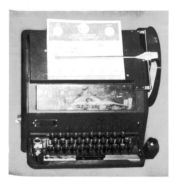
Fig. 1. Fernschreibe-Apparat, ein sogenannter Typing-Reperforator, auf dem die Lochstreifen gestanzt werden Perforateur de bande dit Typing-Reperforator
