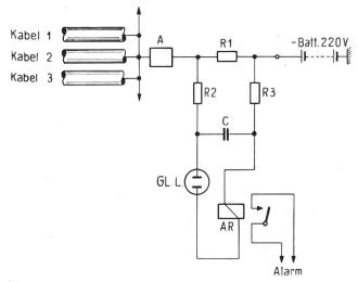
Fig. 9. Prinzipschema des Contrôleur d'isolement 1945 der französischen Verwaltung
