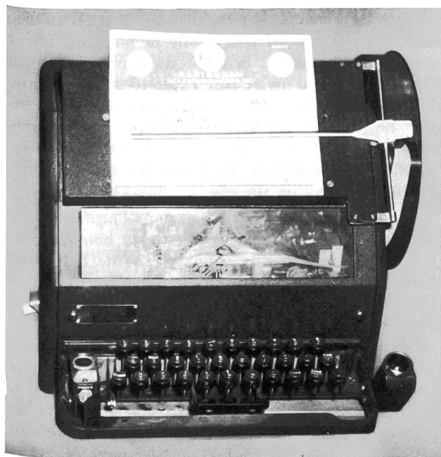
Fig. 1. Fernschreib-Apparat, ein sogenannter Typing-Reperforator, auf dem die Lochstreifen gestanzt werden Perforateur de bande dit Typing-Reperforator
