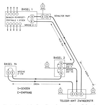
Fig. 2. Schematische Darstellung der umgebauten Rohrpostanlagen in Basel
