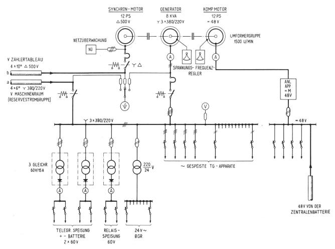
Fig. 7. Prinzipschema der Stromlieferungsanlage
