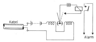
Fig. 2. Automatische Isolations-Überwachung, System Cortaillod
