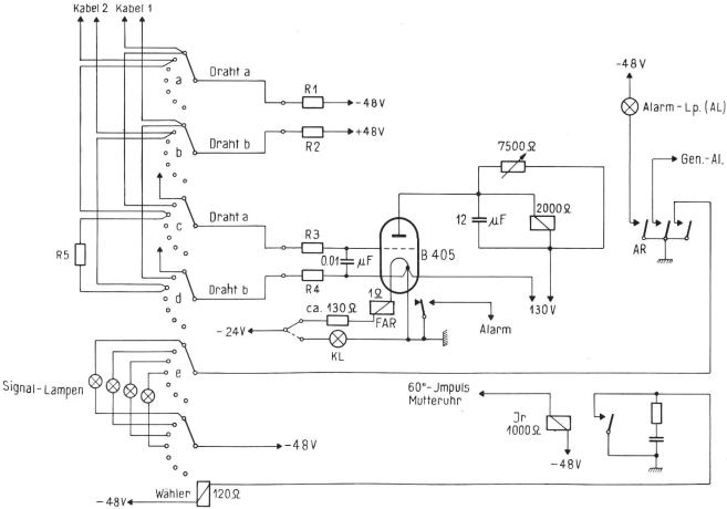
Fig. 6. Schema des automatischen Kabelfehler-Meldeapparates 1943
