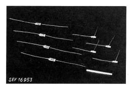
Fig. 5. Condensateurs au papier et céramiques. A gauche: condensateurs au papier 1000 pF, tension continu de service 350 V A droite: condensateurs céramiques 1000 pF, tension continu de service 1000 V
