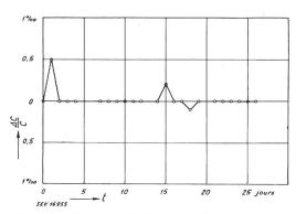
Fig. 7. Contrôle de la stabilité d'un condensateur de précision au mica. Variation de la capacité  $\frac{\Delta\,\mathrm{C}}{\mathrm{C}}$  à + 20° C en fonction du temps t. Condensateur de précision au mica à ± 2°/00 porté chaque jour de + 60° C à — 20° C; condensateur déjà vieilli, non moulé (CN = 1028 pF)
