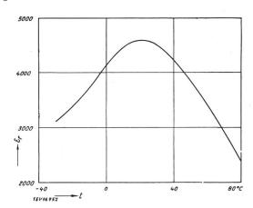
Fig. 4. Pouvoir inducteur spécifique  $\varepsilon_r$  en fonction de la température t d'une céramique américaine (f = 800 Hz)
