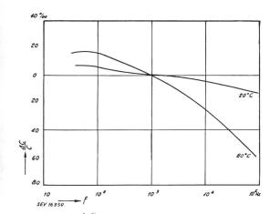
Fig. 2. Variations  $\frac{\Delta C}{C}$ , en fonction de la fréquence f, de la capacité d'un condensateur céramique miniature ( $\varepsilon_r = 3000$ )
