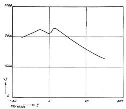
Fig. 3. Pouvoir inducteur spécifique  $\varepsilon_{\rm r}$  en fonction de la température t d'une céramique de fabrication suisse ( $f=800~{\rm Hz}$ )
