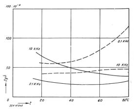
Fig. 1. Angles de pertes tg  $\delta$  d'une céramique à haute constante diélectrique et angles de pertes du papier imprégné d'huile en fonction de la température t— Papier huilé — — Céramique ( $\epsilon_{\rm r}=2000$ )
