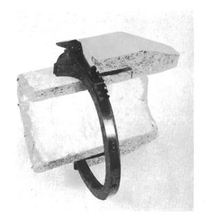
Fig. 3. So soll der Giessring aus Gummi um das Rohr gelegt werden Manière de placer l'anneau autour du tuyau
