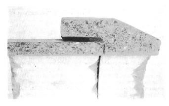
Fig. 7. Schnitt durch eine Rohrmuffe nach dem Ausgiessen Coupe d'un manchon après le coulage
