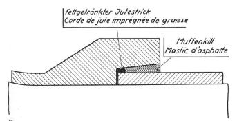
Fig. 1. Schematische Darstellung der Abdichtung Représentation schématique de l'étanchement d'un joint
