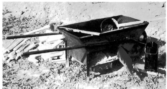
Fig. 2. Heizbare Karrette, in welcher der Muffenkitt dünnflüssig gemacht wird Brouette chauffante servant à rendre le mastic fluide
