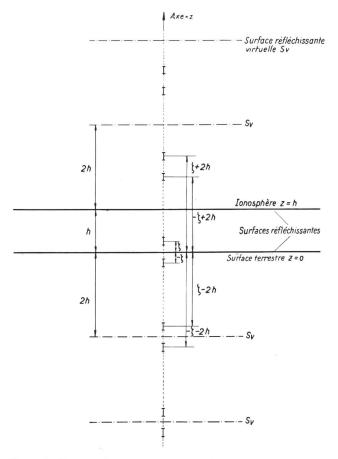
Fig. 2. Réflexion d'une antenne située à une hauteur  $\zeta$  sur la surface terrestre, sur l'ionosphère et sur les surfaces réfléchissantes virtuelles  $S_v$ . Formation d'une série infinie de dipôles
