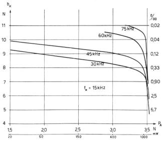
Fig. 15. Klirrdämpfung eines Breitbandverstärkers für Trägerbetrieb
