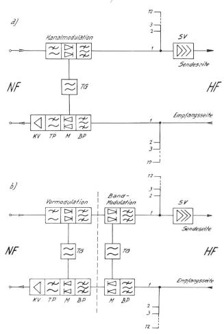
Fig. 3. Schematischer Aufbau von 12-Kanal-Trägersystemen a) einstufig, b) zweistufig
