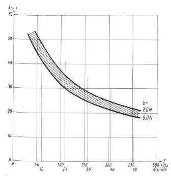
Fig. 13. Verstärkerfeldlänge in Funktion der obern Grenzfrequenz (Kanalzahl) beim Trägerkabel Fig. 11
