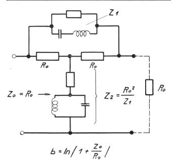
Fig. 16. Entzerrnetzwerk für Trägerkabel
