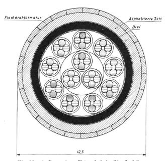
Fig. 11. Aufbau eines Trägerkabels  $24 \times 2$  1,3 mm
