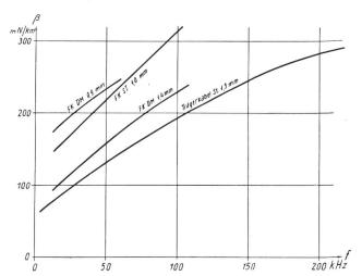
Fig. 12. Wellendämpfung verschiedener Kabeltypen
