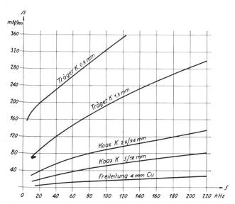
Fig. 18. Wellendämpfung von Träger- und Koaxialkabeln
