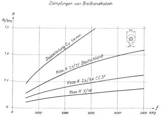
Fig. 19. Wellendämpfung von Koaxialkabeln
