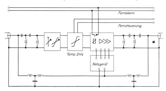
Fig. 22. Prinzip der Stromversorgung von Zwischenverstärkern auf Koaxialkabel-Leitungen
