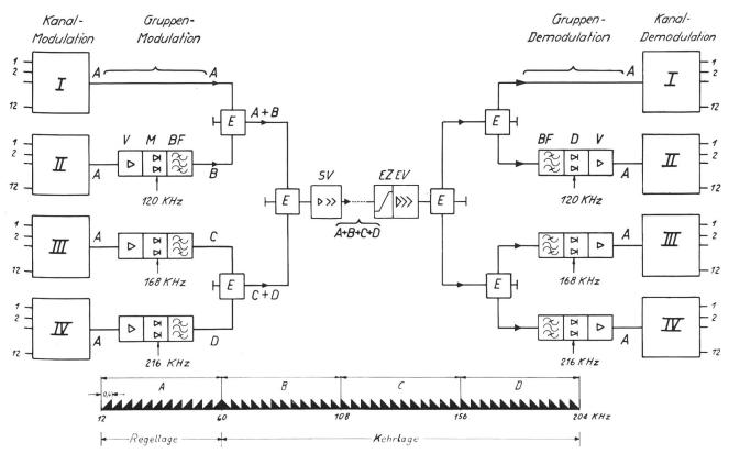
Fig. 5. Prinzipaufbau eines 48-Kanal-Systems
