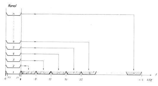
Fig. 2. Prinzip der Mehrfachübertragung von Kanälen durch Versetzen in eine höhere Frequenzlage
