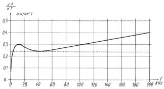
Fig. 17. Temperaturkoeffizient  $\frac{d\beta}{dT}$  eines 1,3-mm-Trägerkabels
