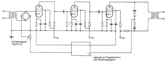
Fig. 14. Prinzipschaltbild eines Breitbandverstärkers für Trägerbetrieb
