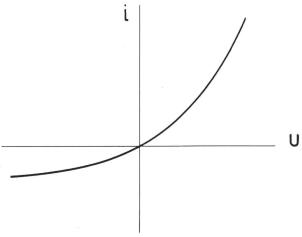
Fig. 7. Charakteristik einer Kristalldiode
