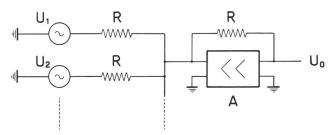
Fig. 2. Addition mit stabilisiertem Verstärker
