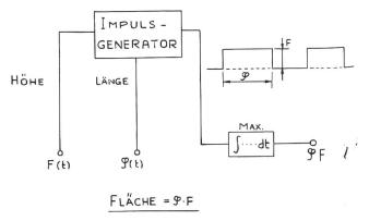
Fig. 8. Multiplikation durch Impulsmodulation
