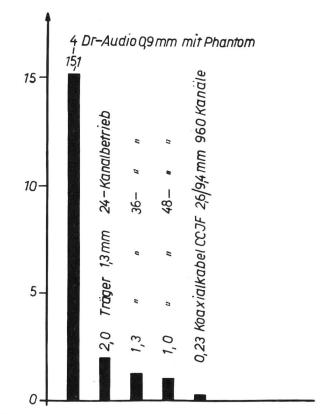
Fig. 1. Kupferbedarf pro km und Sprechkreis für verschiedene Übertragungsverfahren
