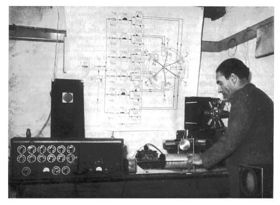
Fig. 6. Le sténo-sonographe phonétique, type SSP 62, pendant la mise en marche par son inventeur. A gauche: partie électronique; à droite: partie mécanique (pabas: scripteur sur cylindre; au dessus: scripteur sur ruban de papier).
