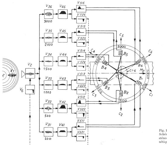
Fig. 1. Schéma de principe du sténo-sonographe phonétique, type SSP 62
