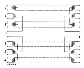
Fig. 5. Prinzip der Superphantomleitung auf Telephonfernkabel  $I = \operatorname{Stamm} 1$   $2 = \operatorname{Stamm} 2$   $I = \operatorname{Vierer} I$   $3 = \operatorname{Stamm} 3$   $4 = \operatorname{Stamm} 4$   $II = \operatorname{Vierer} II$
