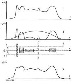
Aufbau eines beliebigen zeitlichen Vorganges durch Fundamentalimpulse
