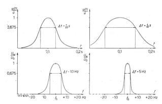
${\bf Fig.~1.~~Glockenf\"{o}rmige~Impulse~verschiedener~effektiver~Zeitdauer}$ mit zugehörigem Frequenzspektrum. Bei modulierter Trägerfrequenzspannung der Frequenz $f_0$  bedeutet der zeitliche Impuls die Hüllkurve
