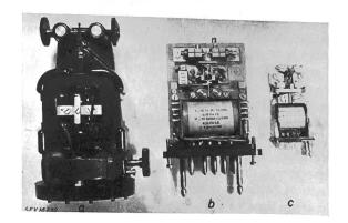
Fig. 12. Polarisierte Relais hoher Empfindlichkeit
