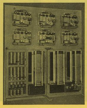
Automatische Wähleinrichtung für eine Gegensprechanlage
