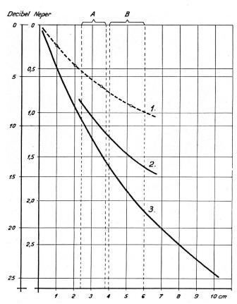
Fig. 6. Affaiblissement de la parole transmise en fonction de la distance entre l'embouchure du microtéléphone et la bouche.  $\beta l = f$  (1 en cm).
