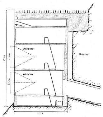
Fig. 4. Coupe d'une fenêtre d'antenne de la station projetée au Jungfraujoch
