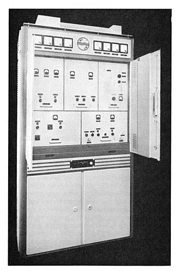
Fig. 1. Versuchs-FM-Sender Philips, Typ FZ 115a
