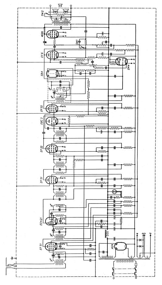
Fig. 6. Schaltschema des Versuchs-FM-Empfängers Philips, Typ FM 46
