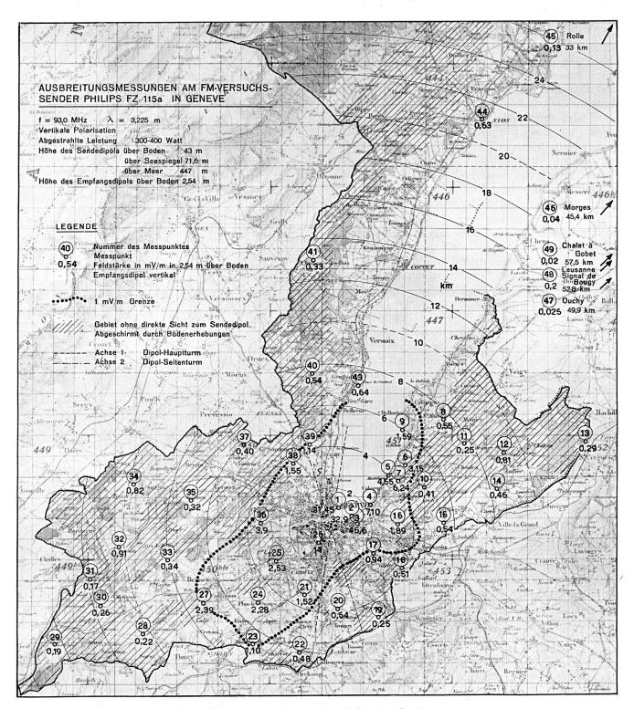
Fig. 7. Feldstärkeplan für vertikale Halbwellen-Sendeantenne
