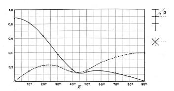
Fig. 9. Turnstile-Antenne. Horizontal- und vertikalpolarisierte Komponenten der Feldstärke in einer vertikalen Mittel-Ebene der Strahler-Ebenen
