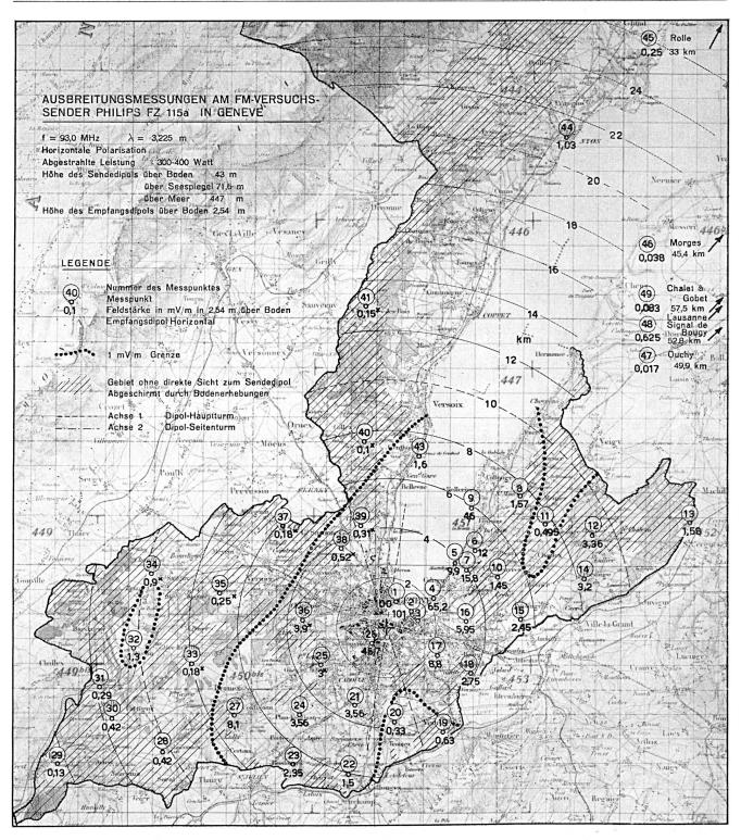
Fig. 11. Feldstärkeplan für horizontalpolarisierte Turnstile-Sendeantenne
