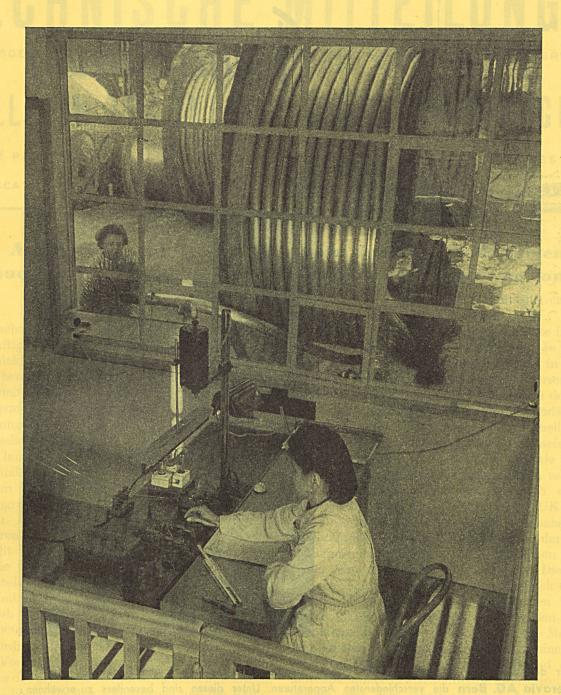
Prüfung eines Telephonbleikabels
