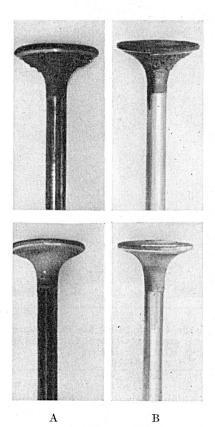
Fig. 5. Ventile A = mit gemischtbasischem Oel geschmiert B = mit HD-Oel geschmiert = Einlassventile oben unten = Auslassventile
