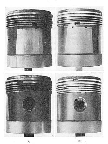
Fig. 2. Kolben Nr. 4 nach 29 000 km Fahrleistung
