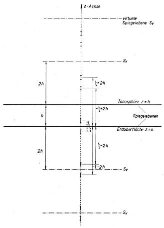
Fig. 2. Spiegelung der Antenne in der Höhe  $\zeta$  an der Erdoberfläche, an der Ionosphäre und an den virtuellen Spiegelebenen Sy. Bildung einer unendlichen Dipolreihe
