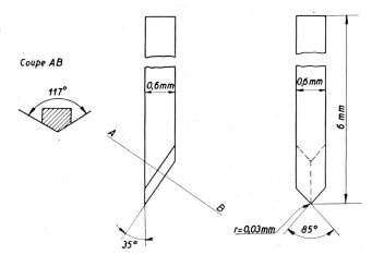
Fig. 6. Abmessungen der Schneidstichel gemäss internationalen Normen
