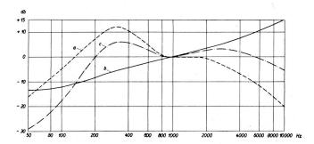
Fig. 1. Aufnahmekurven (Lichtbandbreite)
