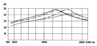
Fig. 4. Nadelgeräuschanalysen von gepressten Platten (4 verschiedene Marken). Bandbreite des Filters 50 Hz Analyses de bruit d'aiguille de 4 disques pressés de marques différentes (bande passante du filtre: 50 c/s)
