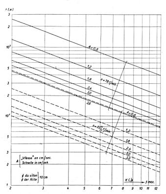
Fig. 10. Grenzefrequenz für eine verzerrungsfreie Wiedergabe in Funktion des Krümmungsradius der Nadel und der Schnelle
