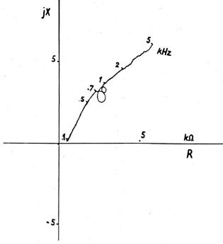
Fig. 5. Scheinwiderstandverlauf eines elektromagnetischen Telephons
