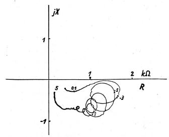
Fig. 8. Scheinwiderstandverlauf eines Pupinkabels mit vorgeschalteter Meßleitung a) im Leerlauf;
