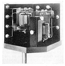
Fig. 2. Ansicht der beiden Dynamometermeßsysteme
