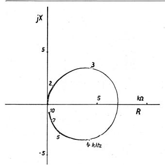
Fig. 4. Scheinwiderstandverlauf eines Parallelresonanzkreises, L = 0,1 Hy; C = 0,02  $\mu$ F; R = 8 kOhm
