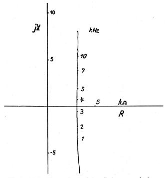
Fig. 3. Scheinwiderstandverlauf eines Serienresonanzkreises, L = 0,1 Hy; C = 0,02  $\mu$ F; R = 3 kOhm
