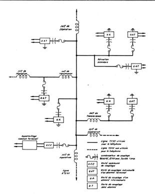
Fig. 30. Schéma des connexions au réseau électrique dans le système de téléphonie à courant porteur M 1  $\,$
