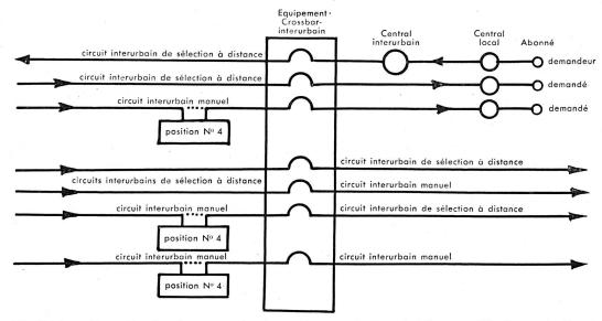
Fig. 25. Schéma des catégories de communications qui peuvent être établies par l'équipement «Crossbar-Interurbain  $N^o$  4» de Philadelphia, Pa.
