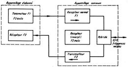
Schema de la Communication d'un abonné rural avec l'exterieur.
