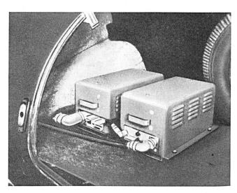
Fig. 33b. Appareillage radio logé dans le caisson arrière de la voiture
