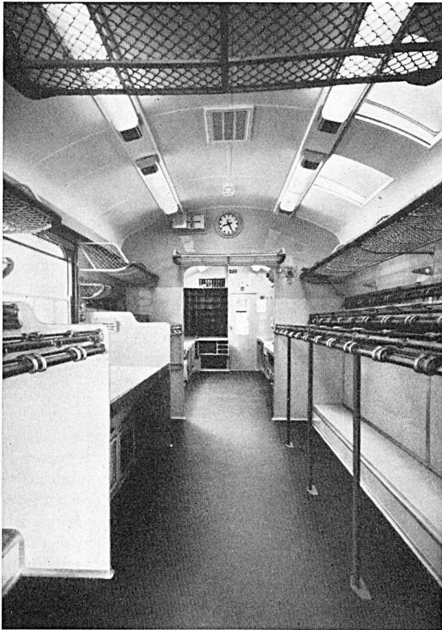
Fig. 17. Beleuchtung eines Bahnpostwagens. Durchblick vom Sackraum ins Bureau. U-förmige Kaltkathoden-Fluoreszenzlampen in Diffusoren aus Plexiglas. Installierte Leistung 700 W ab Batterie. Lichtquelle 4500° K. Stromquelle: Vibratoren zur Umformung des Gleichstroms in Wechselstrom 50 Hz. Baujahr 1947/48
