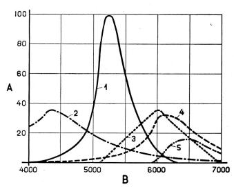
Fig. 1. Spektrale Energieanteile farbiger Fluoreszenzlampen. Lampen gleicher Wattstärke, ohne Berücksichtigung der Quecksilberdampflinien (nach Westinghouse
