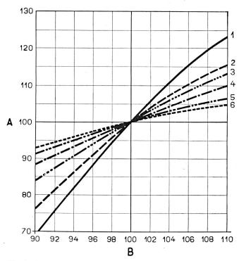
Fig. 9. Spannungsabhängigkeit der Fluoreszenzlampen Effets des variations de tension sur les lampes fluorescentes Legende — Légende:
