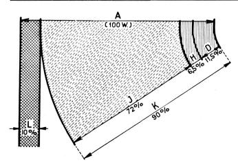
Fig. 5. Verteilung der Energie, die durch eine 100-W-Glühlampe (1500 lm) konsumiert wird
