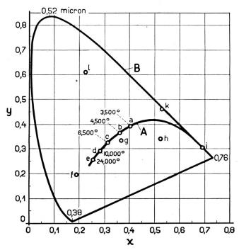
Fig. 4. Farbenkennzeichnung nach dem I.C.I. - (International Commission on Illumination-) System
