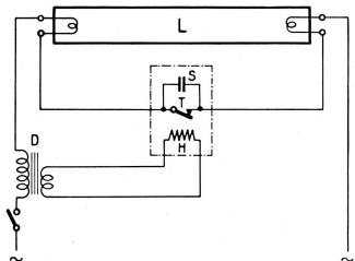
Fig. 12. Schaltung mit thermischem Starter
