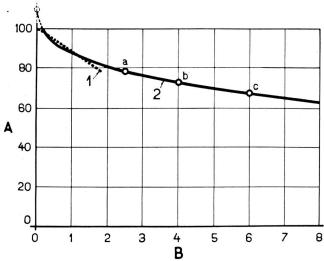
Fig. 10. Lichtemission in Abhängigkeit der Lebensdauer Relation entre l'émission lumineuse et la longévité Legende — Légende:
