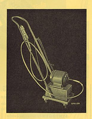
Fahrbare Maschine zum Abisolieren von Drähten
