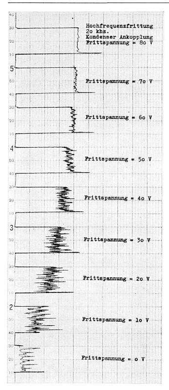
Fig. 5. Frittwirkung von Hochfrequenz mit Kondensatorankopplung
