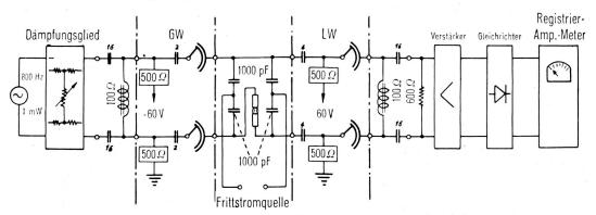
Fig. 4. Schaltungsanordnung für die Bekämpfung von Schwunderscheinungen
