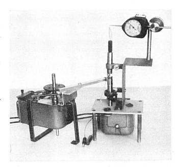
Fig. 2. Schwunderzeuger mit Erschütterungsvorrichtung. Links Hammerwerk, rechts Schwunderzeuger
