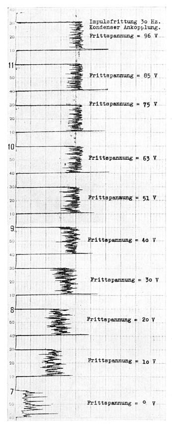
Fig. 6. Impulsfrittung mit Kondensatorankopplung
