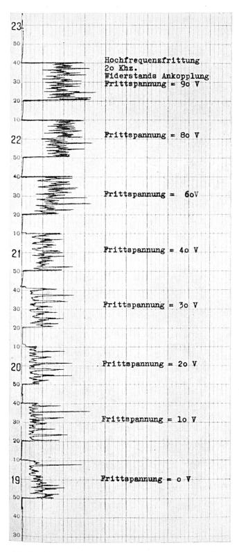
Fig. 7. Frittwirkung von Hochfrequenz mit Widerstandsankopplung
