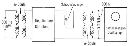
Fig. 3. Schaltungsanordnung für die Erzeugung von Schwunderscheinungen
