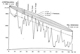
Fig. 11. Geländeprofil Jungfraujoch Nordostrippe (3660 m ü. M.)
