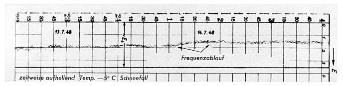
Fig. 16. Beispiel einer Feldstärkeregistrierung mit 2-m-Wellen zwischen Monte Generoso und Jungfraujoch (Reproduktion des Registrierbandes).
