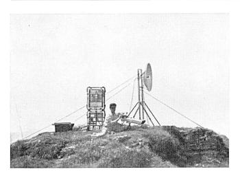
Fig. 3. Sender der 15-cm-Impulsanlage auf dem Monte Generoso, in der Nähe des Hauptgipfels; Parabolspiegel nach dem Jungfraujoch gerichtet
