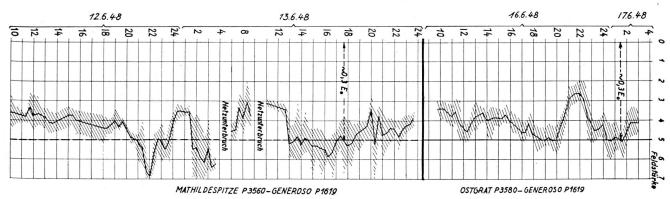
Fig. 14. Beispiel einer Feldstärkeregistrierung mit 15-cm-Wellen zwischen Monte Generoso und Jungfraujoch.
