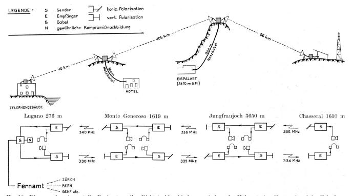
Fig. 10. Die versuchsweise erstellte Dezimeterwellen-Richtstrahlverbindung zwischen der Höhenstation Chasseral und der Telephonzentrale Lugano, wie sie am 26. August 1948 den Teilnehmern der PTT-Direktoren-Konferenz auf dem Chasseral vorgeführt wurde
