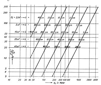
Zusätzlicher Verlust br. an übertragener Leistung durch einen künstlichen Sekundärstrahler gegenüber freier Ausbreitung. Die Formel gilt näherungsweise, solange die Voraussetzung der ebenen Welle über die betrachteten Antennenöffnungen erfüllt ist
