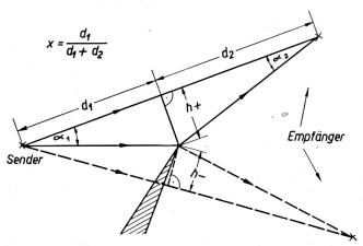
Fig. 23. Wellenbeugung an einer absorbierenden Kante
