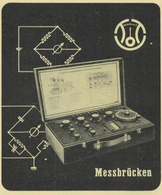
Wheatstone- und Thomsonbrücken, Kompensationsapparate, Hochspannungsmessbrücken nach Schering
