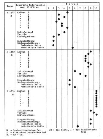
Fig. 25. Bewertung des Zustandes der Motoren nach 50 000 km
