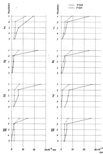
Fig. 24. Abnützung der Zylinderbüchsen nach 50 000 km (belastete Seite)
