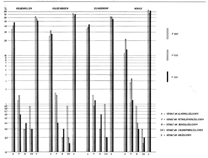
Fig. 20. Lösungsmittelextraktion von Rückständen
