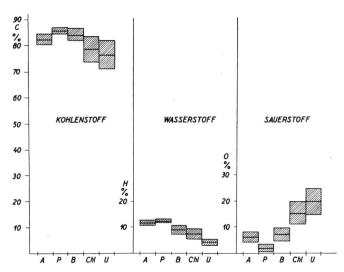
Fig. 22. Die chemische Zusammensetzung verschiedener Lösungsmittelextrakte, die aus Schmierölrückständen erhalten wurden (Mittelwert und Streubereich) nach H. Stäger und H. Künzler
