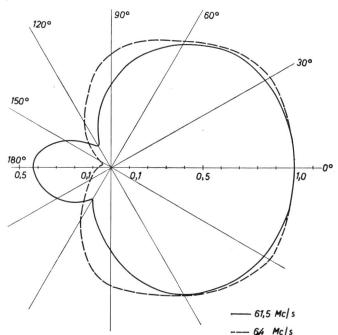
Fig. 3. Diagramme polaire de réception de l'antenne
