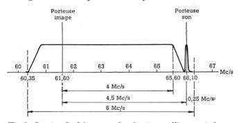
Fig. 1. Spectre de fréquences des émetteurs d'image et de son d'après les normes Philips
