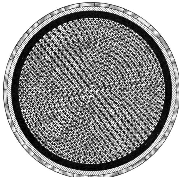
Fig. 26. Sternviererverseiltes Teilnehmerkabel zu  $1204 \times 2$  Adern (602 Vierer). Durchmesser über der Armatur 87,4 mm. Gewicht pro Meter 22 kg. Einführung dieses Kabeltyps in der Schweiz im Jahre 1924
