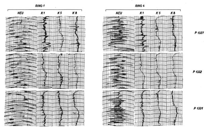
Fig. 13. Oberflächengüte der Kolbenringe, neu und nach 50 000 km Netzlinienabstand quer =  $0.25 \mu$ , Länge der Messkurven = 1.6 mm auf dem Kolbenring
