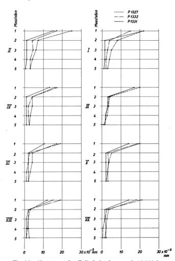
Fig. 16. Abnützung der Zylinderbüchsen nach 50 000 km (unbelastete Seite)
