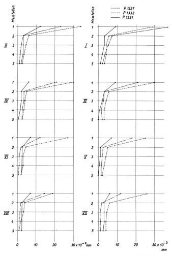
Fig. 15. Abnützung der Zylinderbüchsen nach 50 000 km (belastete Seite)
