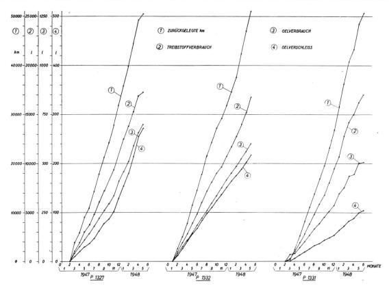
Fig. 8. Betriebsdaten während der Dauer des Versuches
