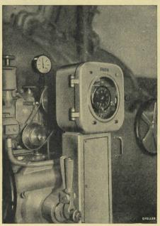
Steuerplatine mit Registrier-Empfänger, Turbinen-Regulierung
