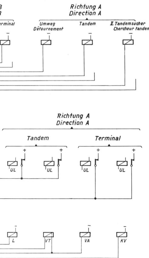
Les relais KV, VA, VT et L remplissent les fonctions suivantes: Le relais KV doit être excité quand aucune amplification n'est nécessaire entre un circuit interurbain entrant et un sortant.
