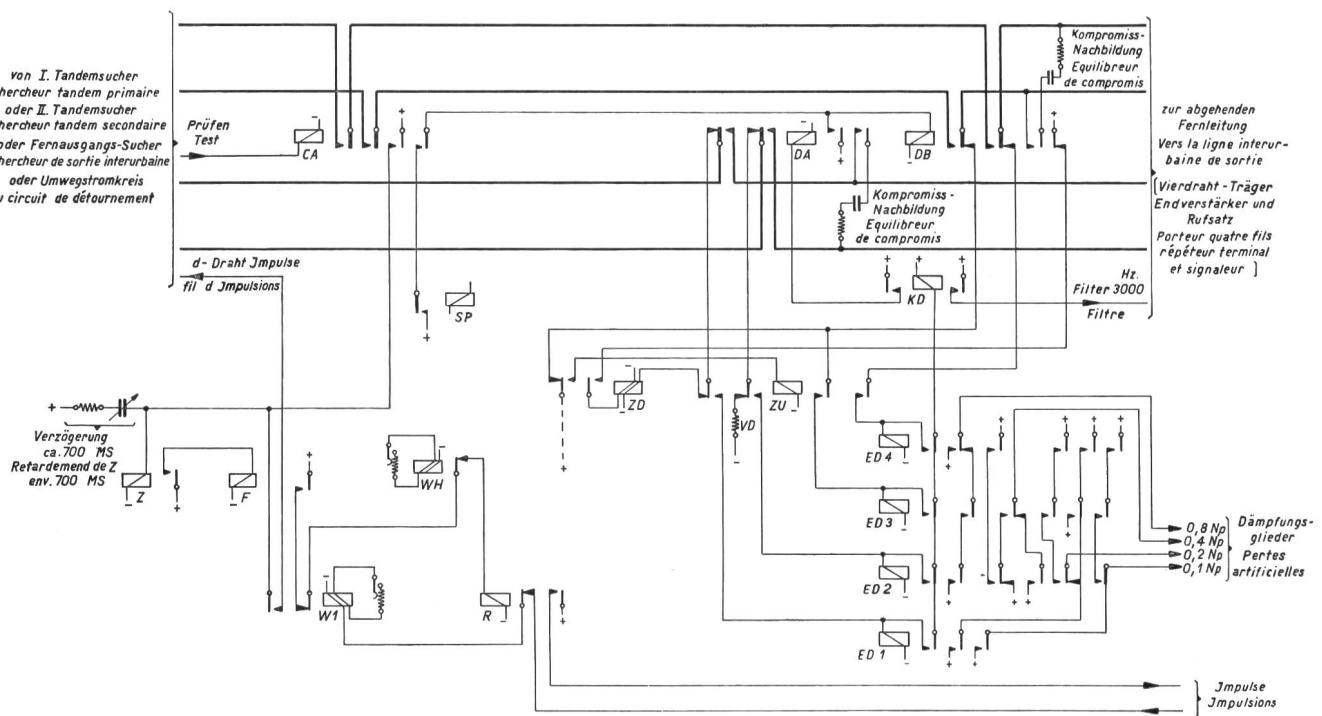
Fig. 9. Abgehender Fernlinien-Stromkreis Vierdraht — Circuit interurbain sortant à quatre fils
