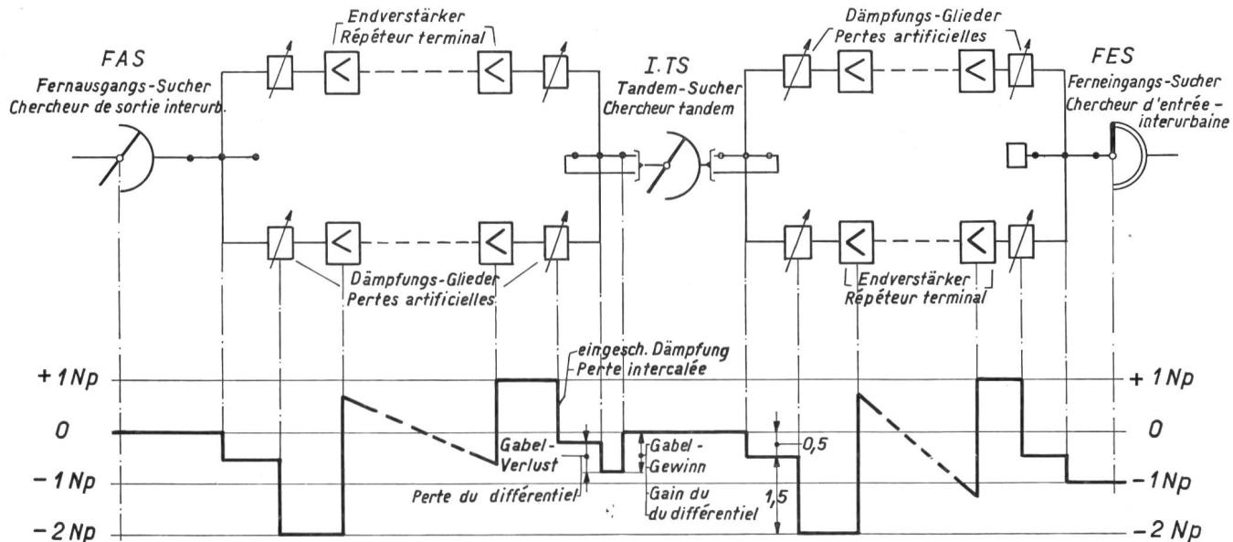
Fig. 5. Vierdraht-Vierdraht-Tandemverbindung — Communication quatre fils-quatre fils
