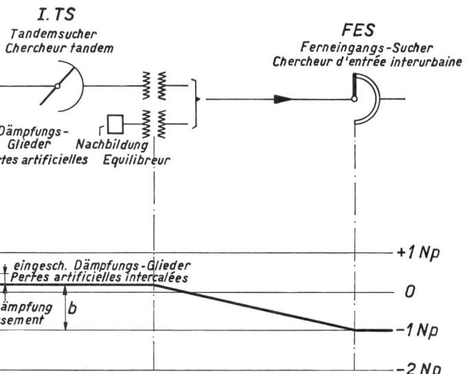
Fig. 2. Zweidraht-Zweidraht-Tandemverbindung — Communication tandem deux fils-deux fils
