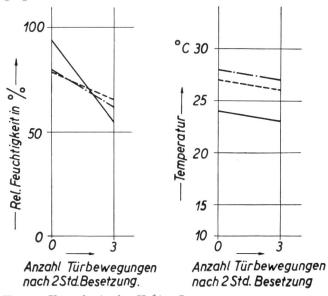
Fig. 10. Versuche in der Kabine I Veränderungen der relativen Luftfeuchtigkeit (links) und der Temperatur der Kabinenluft (rechts) durch dreimaliges Türöffnen nach zweistündiger Benützung der Kabine
