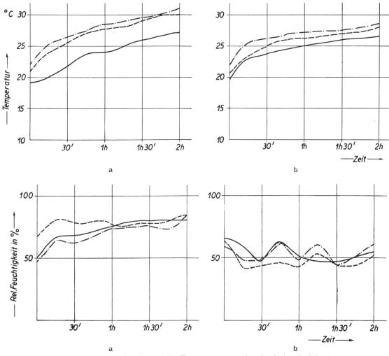
Fig. 5. Versuche in der Kabine II; Temperaturverlauf und relative Luftfeuchtigkeit a = mit abgestelltem Ventilator b = mit laufendem Ventilator ———— Meßstelle 10 cm über dem Boden ————— Meßstelle 110 cm über dem Boden —————— Meßstelle 180 cm über dem Boden
