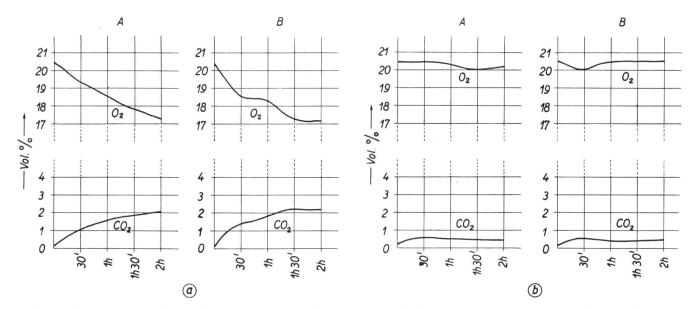
Fig. 6. Versuche in der Kabine II. Veränderung des Sauerstoff- bzw. Kohlensäuregehaltes der Kabinenluft während einer zweistündigen Benützungsdauer
