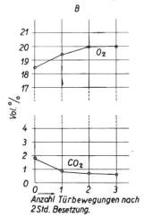
Fig. 9. Versuche in der Kabine I Veränderung des Sauerstoff- bzw. Kohlensäuregehaltes der Kabinenluft durch mehrere Türbewegungen nach zweistündiger Benützung
