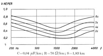
Fig. 5. Frequenzabhängigkeit der Betriebsdämpfung einer mit H-15,5 pupinisierten Kabelleitung für verschiedene Anzahl Spulenfelder bei einem Aderdurchmesser von 0,8 mm
