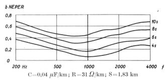
Fig. 6. Frequenzabhängigkeit der Betriebsdämpfung einer mit H-15,5 pupinisierten Kabelleitung für verschiedene Anzahl Spulenfelder bei einem Aderdurchmesser von 1,2 mm
