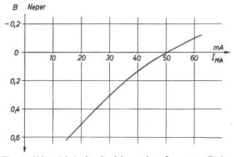
Fig. 1. Abhängigkeit der Sendebezugsdämpfung vom Speisestrom des Mikrophons
