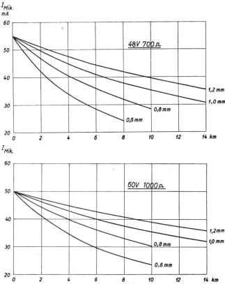
Fig. 2. Mikrophonstrom bei verschiedenen Aderdurchmessern in Abhängigkeit von der Kabellänge
