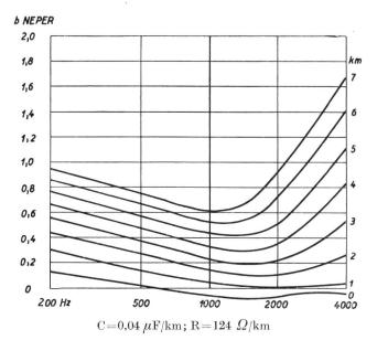
Fig. 3. Frequenzabhängigkeit der Betriebsdämpfung einer unpupinisierten Kabelleitung für verschiedene Längen bei einem Aderdurchmesser von 0,6 mm
