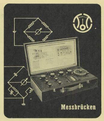
Wheatstone- und Thomsonbrücken, Kompensations-apparate, Hochspannungsmessbrücken nach Schering
