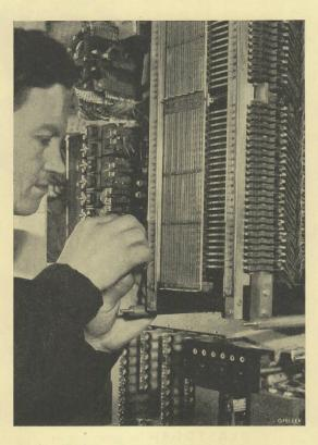
Montieren eines Leitungsdurchschalters
