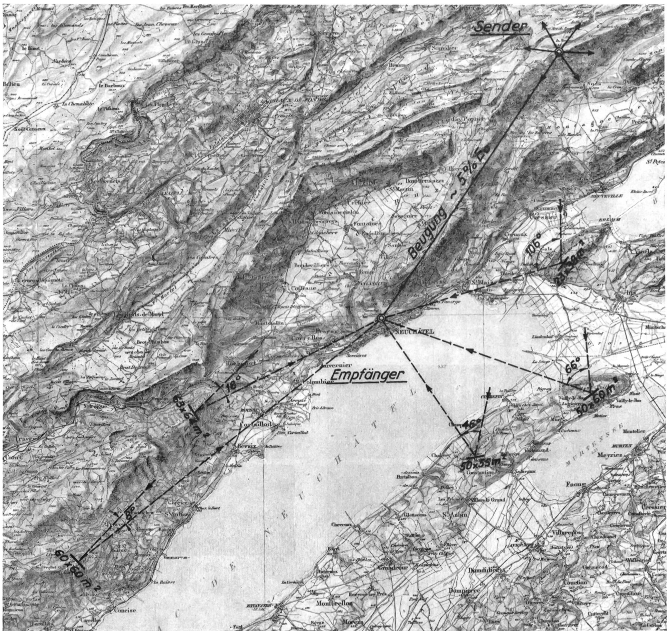
Fig. 41. In der Gegend von Neuenburg hauptsächlich störende Sekundärstrahler (siehe auch Fig. 42). Die bei den einzelnen Reflektoren angegebenen Zahlen beziehen sich auf die Fläche (Höhe mal Breite) eines idealen Ersatzspiegels, welcher an dem betreffenden, möglichst günstig gewählten Mess-Standort in Neuenburg dieselbe Feldstärke ergeben würde. Siehe Text
