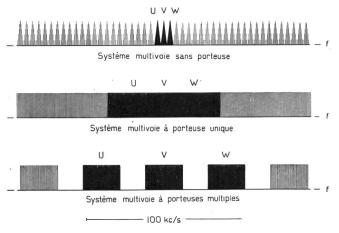
Fig. 3. Spectres de téléphonie multivoie par ondes ultra-courtes
