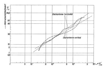
Fig. 27. Mindestfeldstärke für störungsfreien Empfang  $\sigma_{\rm A}=60~{\rm db}$ , bezogen auf die Messung der Quasi-Maxima innert 5 Minuten. Ländliche Verhältnisse mit durchgehendem Autoverkehr (40% Zündstörungen). (Die dick gezogene Kurve entspricht dem effektiven Verlauf der Messpunkte)
