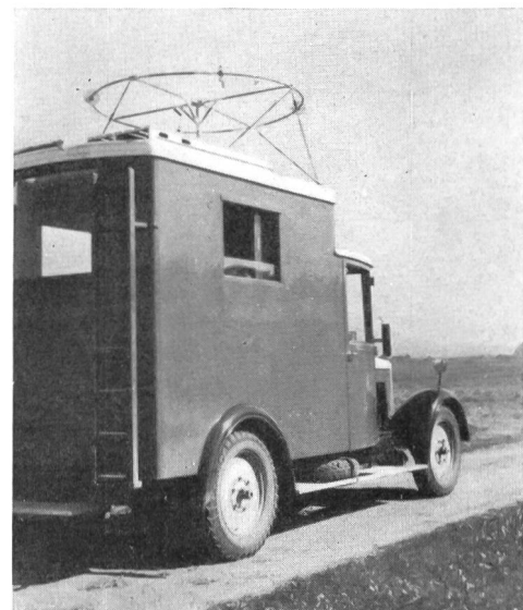
Fig. 8. Feldstärke-Messwagen mit Rundempfangsantenne für horizontal polarisierte Wellen. f = 50 \text{ MHz}
