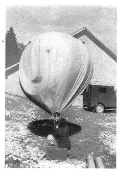
Fig. 3. Feldstärkemessungen mit Hilfe einer Ballonsonde. Der Ballon auf dem Chasseral kurz vor dem Aufstieg
