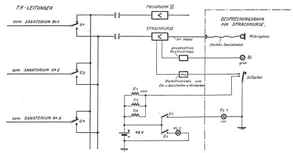
Fig. 4. Schema der Besprechungsanlage im PTT-Gebäude Davos
