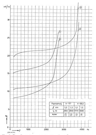
Fig. 1. Berechnete kilometrische Dämpfung  $\beta$  von Pupinkabeln f= Frequenz,  $f_0=$  Grenzfrequenz
