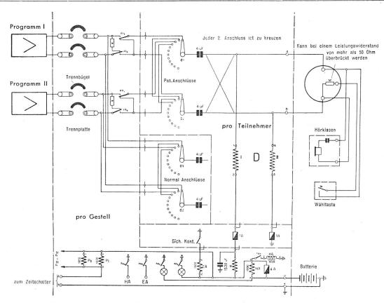
Fig. 6. Schaltung einer Musikübertragungsanlage mit besonderen Musikleitungen
