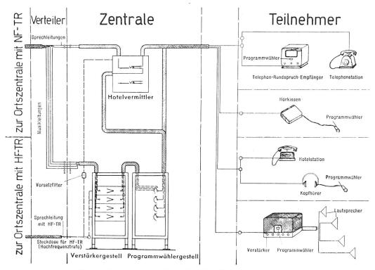
Fig. 1. Prinzipieller Aufbau einer Musikübertragungsanlage
