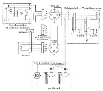
Fig. 7. Schaltung bei gleichzeitiger Verwendung der Telephonleitung als Musikleitung
