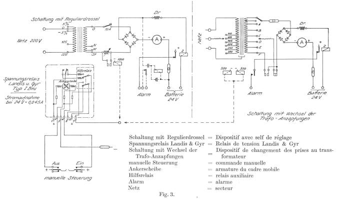
Schaltungsarten für das Landis & Gyr-Spannungsrelais in Batterie-Ladeeinrichtungen (kombinierte Schwebe- und Starkladung) Connexions du relais de tension Landis & Gyr dans les installations de charge (charge poussée et charge flottante combinées)
