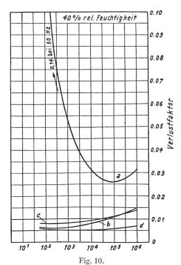
Wechselstrom Verlustfaktor acetylierter Zellulose-Garne
