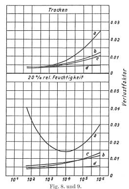
Wechselstrom Verlustfaktor acethylierter Zellulose-Garne
