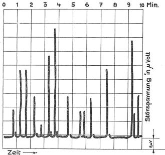
Fig. 3. Störspannungen durch Isolationsfehler
