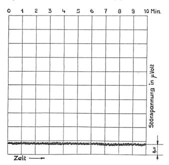
Fig. 2. Störspannungen durch Schroteffekt
