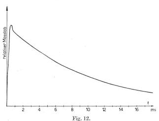
Übertragungsfunktion des entzerrten Kondensatormikrophons
