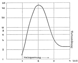
Fig. 1. Abhängigkeit des Schroteffektes von der Heizspannung
